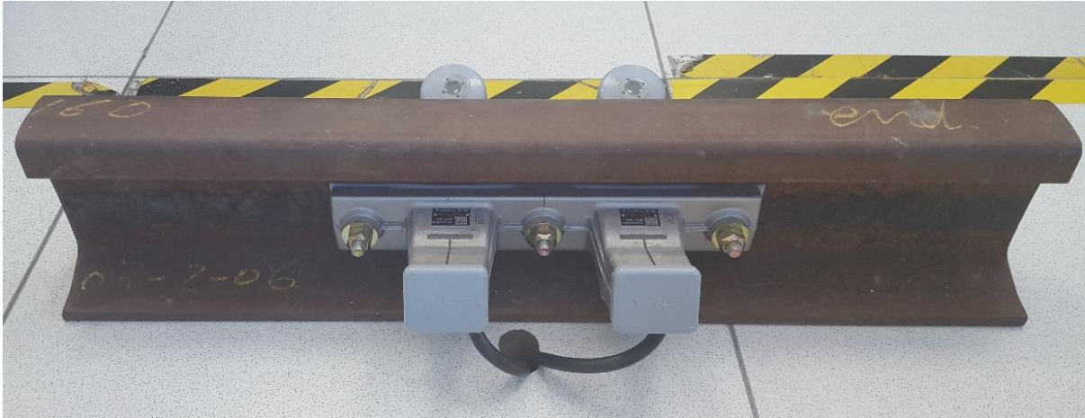
Figura 3.42. Contador electrónico de ejes de THALES. Elaboración propia.
