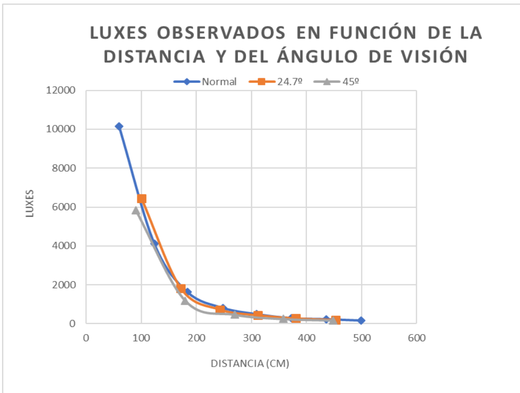
Figura 38: Luxes observados utilizando como fuente de iluminación Halolux de 150W a diferentes distancias
