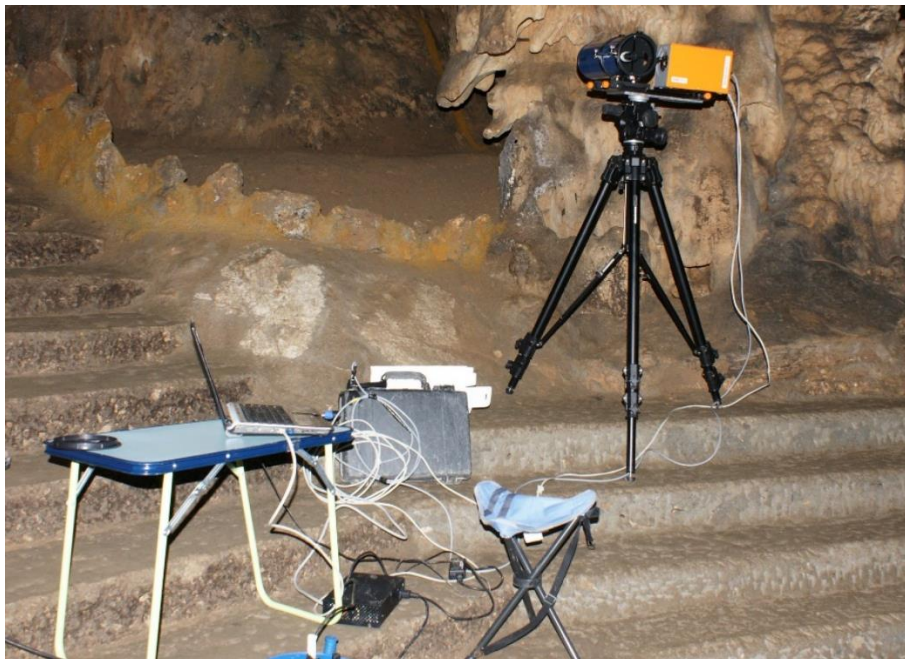
Figura 48: Sensor IRCAM GIM con óptica abierta funcionando en el interior de la cueva.
