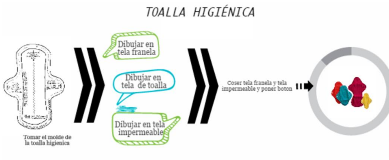
Figura 28 Procedimiento para la elaboración de una toalla sanitaria articulando el enfoque ancestral y el científico.
