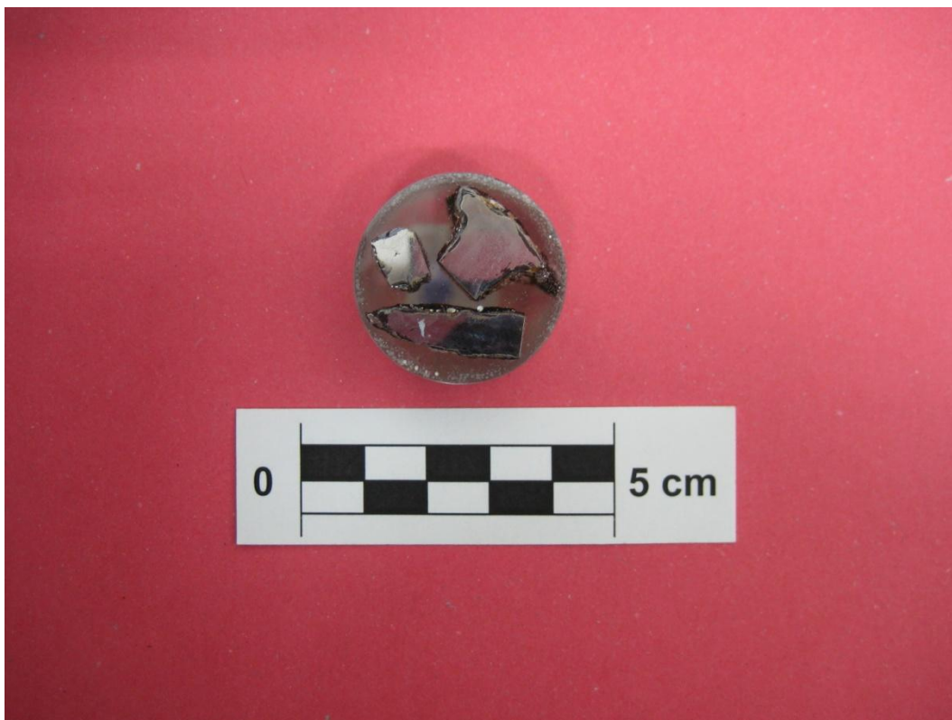
Figura 31. Ejemplo de probeta pulida.
