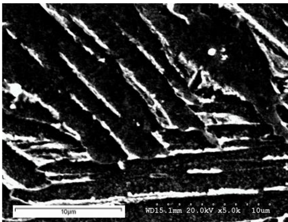
Figura 150. Imagen de MEB mostrando que a partir de las 1176 horas de calentamiento a 300° C las imágenes que se aprecian se parecen mucho a las observadas en las muestras arqueológicas estudiadas. Es evidente la masiva precipitación de los carburos de hierro, empezándose a distinguir el crecimiento a partir de los límites de grano y su orientación en estructura Windmanstätten.
