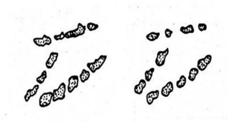
Figura 190. Fase de segmentación de la cementita (Fuente: Calvo et al. , 1985: 312-316).
