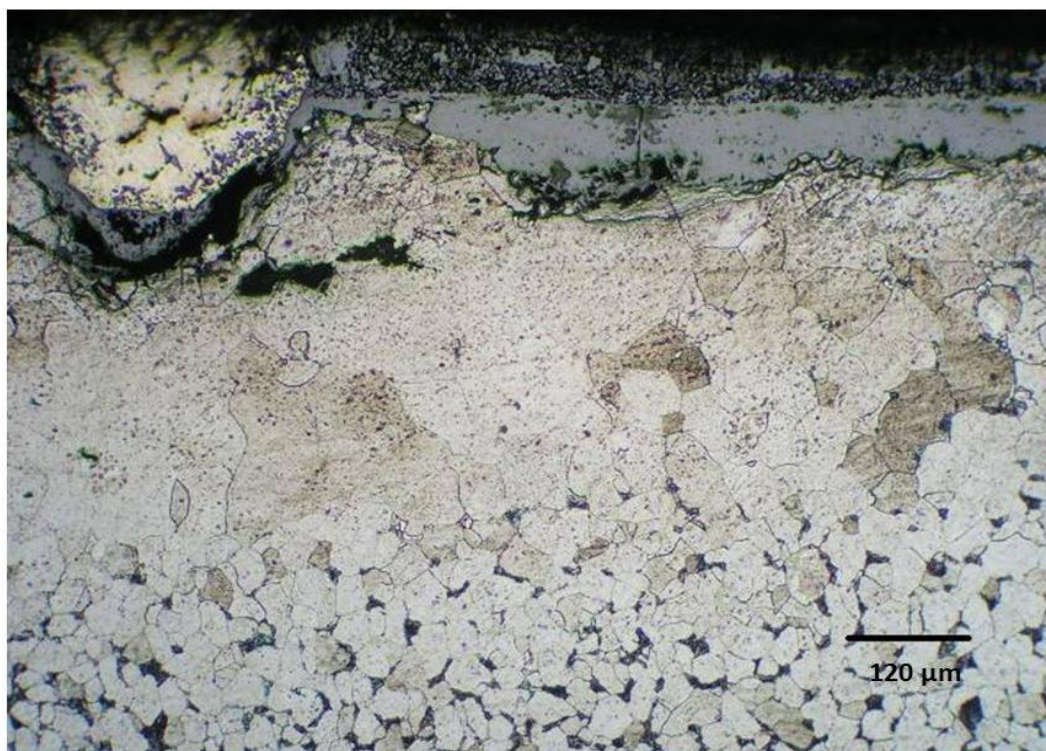
Figura 82. Imagen de Microscopía Óptica mostrando el sustrato de bronce con la capa de magnetita que lo recubre. En la parte superior izquierda resalta la sección con uno de los hilos de plata que fundieron. Se observa como los granos de ferrita con los precipitados de carburo de hierro están presentes en el núcleo metálico de la pieza (Fuente: Museo Armería de Vitoria-Gasteiz).
