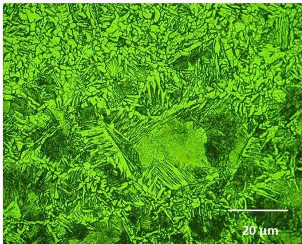
Figura 109. Imagen de Microscopía Óptica con campo claro y filtro verde donde ya se evidencian las dos fases de escalonamiento y globulización y crecimiento.
