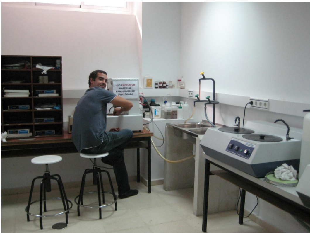
Figura 30. Fase de pulido en máquina pulidora de la marca Remet tipo LS2.
