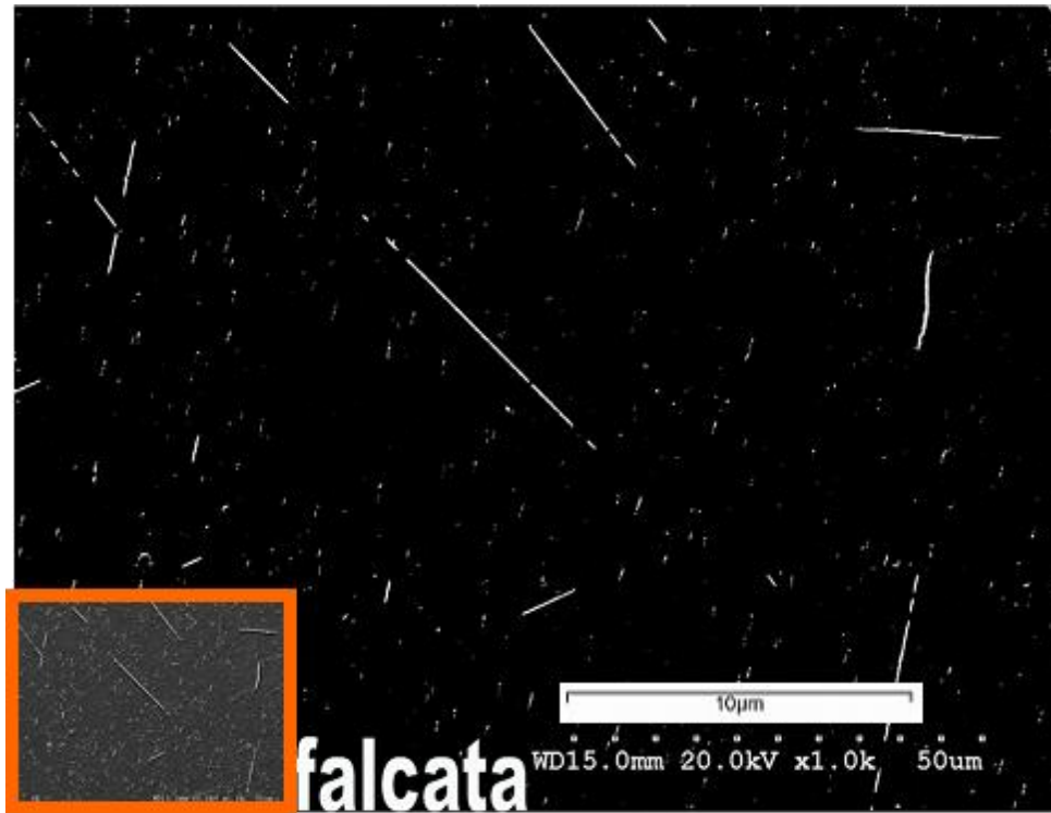
Figura 159. Imagen de MEB mostrando los carburos de hierro de la falcata con el fin de compararlos con los formados en las muestras experimentales.
