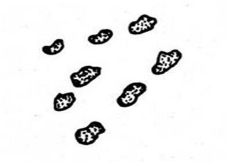
Figura 191. Fase de globulización de la cementita (Fuente: Calvo et al. , 1985: 312-316).
