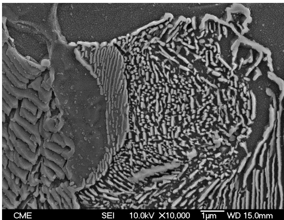
Figura 136. Imagen de MEB mostrando un espaciado interlaminar fino. Éste depende de si el enfriamiento se ha llevado a cabo en el horno o al aire, esto es, depende de la velocidad de enfriamiento. En este caso se ha producido un laminado en caliente con un enfriado al aire desde campo austenítico (900° C).
