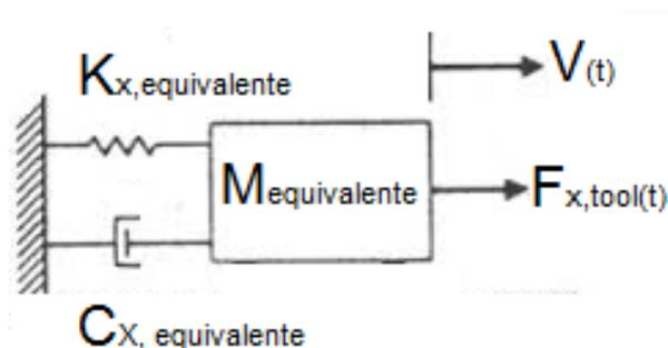
**Ilustración 2.21 Representación analógica del robot ABB IRB 6660**
