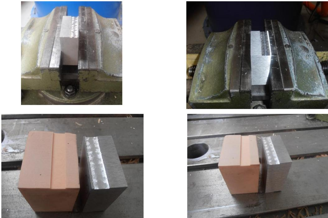
**Ilustración 3.76 Probetas mecanizadas en Aluminio y PUR.**
