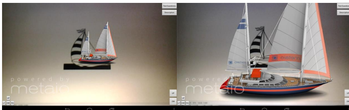
Figura 83. Ejemplo de escalado de un objeto 3D. A la izquierda se sitúa el objeto en su tamaño original. A la derecha se presenta la imagen del objeto tras pulsar el botón UP que permite aumentar su tamaño proporcionalmente en X,Y,Z.
