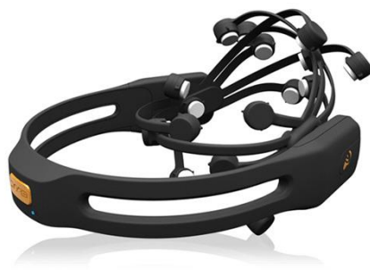
Figura 8. Emotiv-Epoc.(web emotiv.com) Interfaz Cerebro-Máquina.
