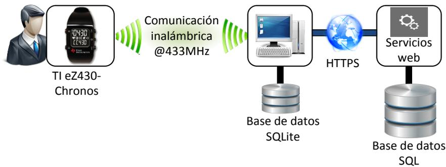
Figura 7.2. Prototipo de arquitectura para la monitorización
